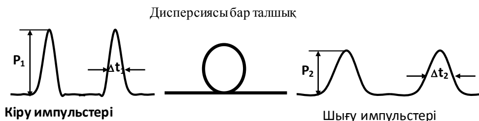
Сурет 2.9 - Импульс енінің өзгеруі олардың ең жоғарғы қуатының өзгеруімен және қуат бойынша айыппұлмен сипатталады: q = 10 \log(P_1/P_2) = 10 \log(\Delta t_2/\Delta t_1) .
